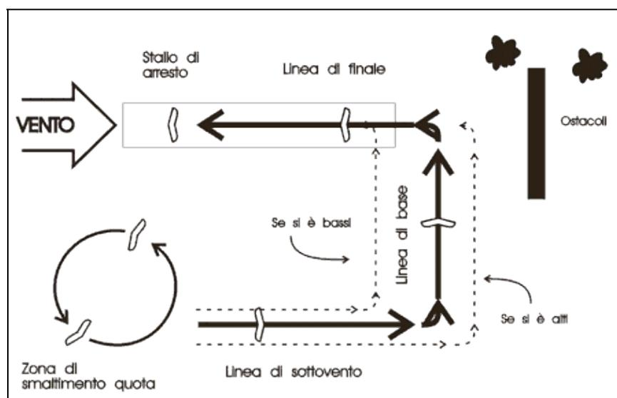
**Figura 2-3.** Circuito a "C": lo smaltimento di quota avviene sopravvento alla pista, senza sorvolarla; il circuito consente di "allungare" od "accorciare" il tratto di sottovento per correggere eventuali errori nella valutazione della quota.
