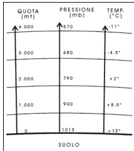
**Figura 4-7.** Gradiente termico e gradiente barico (pressorio) medi nei primi 4.000 metri di altezza s.l.m.
