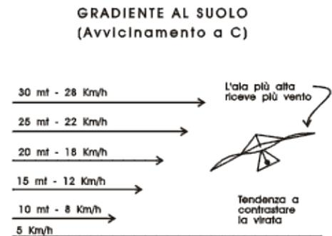
**Figura 5-28.** Il gradiente di vento (se sostenuto) determina una tendenza a contrastare le ultime virate dell'avvicinamento a C.
