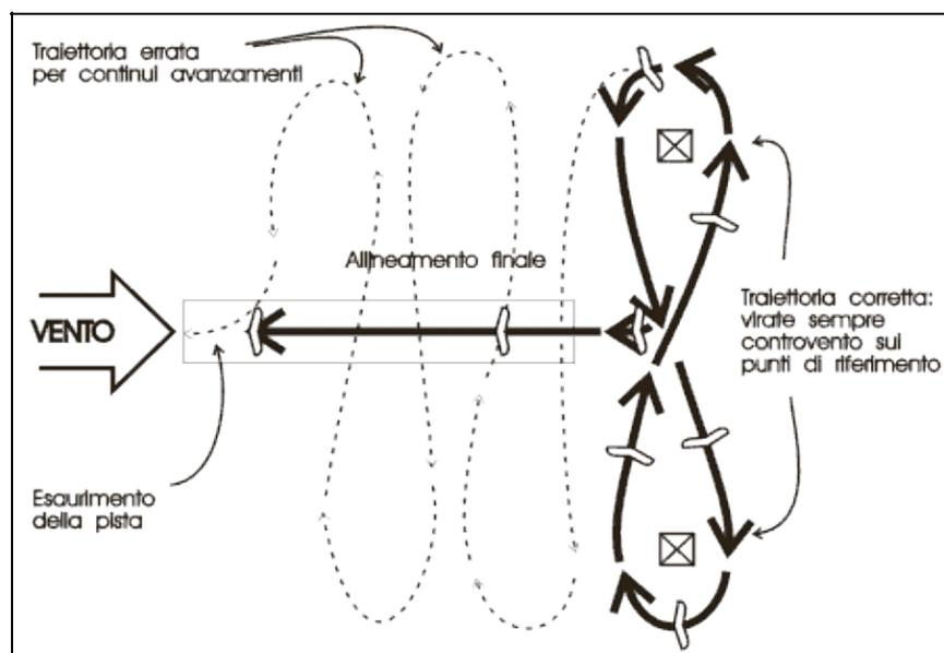
**Figura 2-4.** Circuito ad 8: i riferimenti al suolo verranno presi considerando l'efficienza del mezzo (deltaplani più arretrati, parapendio più vicini all'inizio della pista) e l'intensità del vento (tanto più avanzati quanto maggiore è il vento); la assenza riferimenti al suolo genera l'errore di avanzare ad ogni virata "mangiandosi" la pista di atterraggio
