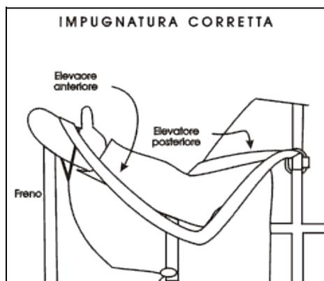
Figura 6-7. Impugnatura corretta: l'elevatore posteriore passa sopra all'avambraccio
