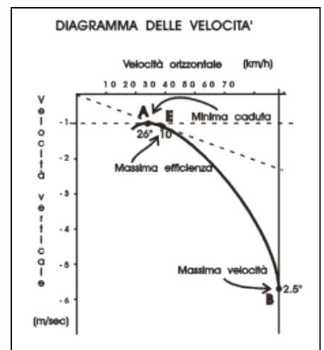
Figura 3-18. Diagramma delle Velocità.
