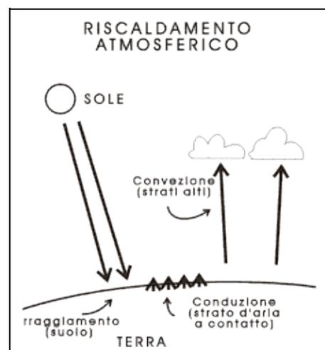
**Figura 4-6.** Formazione del gradiente termico verticale dell'atmosfera.
