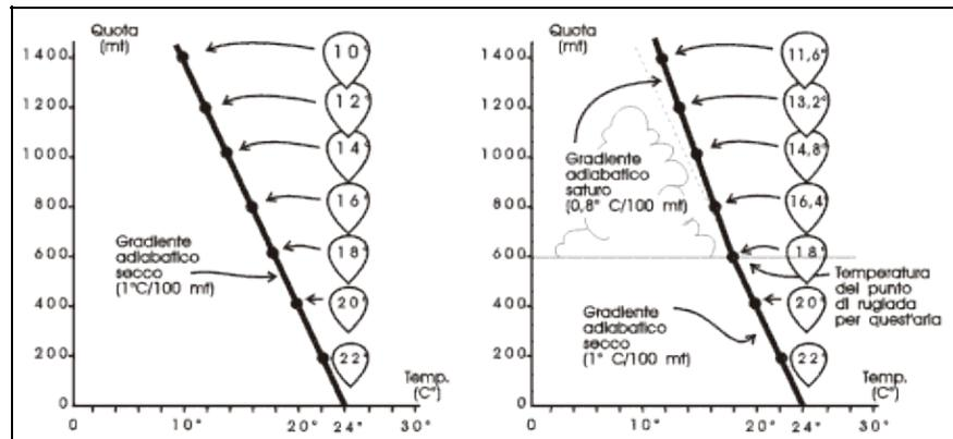
**Figura 4-8.** I gradienti adiabatici indicano di quanto una massa d'aria, circondata da aria più fredda, si raffredda mentre sale e si espande.
