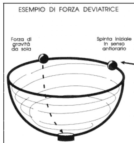
**Figura 4-24.** Una piccola spinta laterale determina un movimento rotatorio sulla pallina sottoposta alla forza di gravità.
