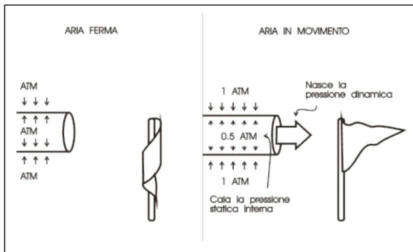
**Figura 3-4.** La pressione statica, all'interno di un tubo di gomma, è pari a quella atmosferica. Quando l'aria è posta in movimento si genera una pressione dinamica che cresce a scapito di quella statica.
