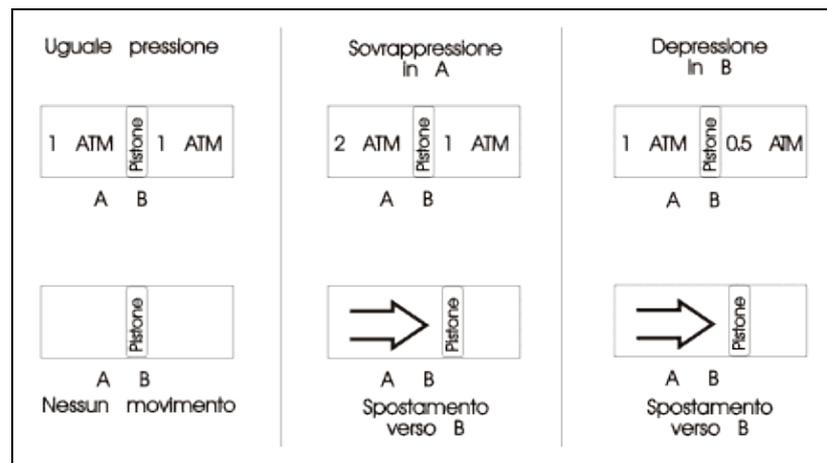
**Figura 3-3.** Ciò che determina lo spostamento del separatore mobile è la differenza di pressione tra A e B: ciò può essere ottenuto sia determinando una sovrappressione in A sia riducendo la pressione in B.
