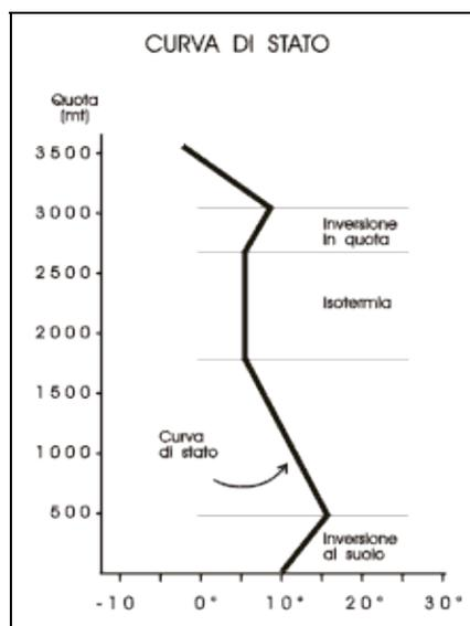
**Figura 4-9.** La curva di stato indica come varia la temperatura al variare della quota: si notino le inversioni termiche (sia al suolo che in quota). In base alla curva di stato (rilevata giornalmente) è possibile individuare le condizioni di equilibrio dell'aria.
