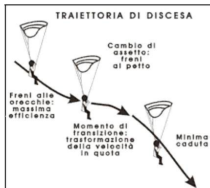
**Figura 6-18.** Il passaggio dalla velocità di massima efficienza a quella di minima caduta peggiora la traiettoria di discesa anche se, per qualche istante, si ha l'impressione opposta: questo fenomeno momentaneo è dovuto alla trasformazione della maggior velocità precedente in "quota".
