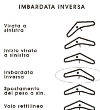
**Figura 5-23.** L'imbardata inversa è percepibile, con apparecchi molto allungati, alle basse velocità.
