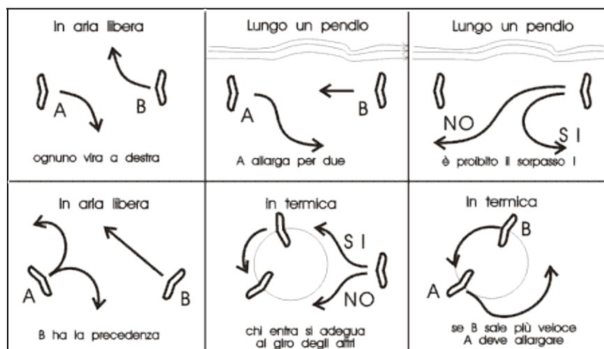
**Figura 2-2.** Le precedenze in volo: vale la regola generale della precedenza a destra (come in auto), con la necessaria eccezione del volo lungo un costone. In termica, inoltre, si deve girare nello stesso senso di chi già è all'interno, ed "allargare" la traiettoria se qualcuno sale più velocemente di noi.
