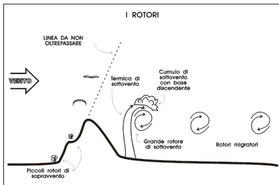
**Figura 4-17.** I rotori che si formano sottovento ad una montagna possono staccarsi da essa e ritrovarsi anche a diversi chilometri di distanza (rotori migratori); sono da evitare anche i piccoli rotori di sopravvento, tanto più forti quanto più angolato è il "raccordo" tra montagna e pianura.
