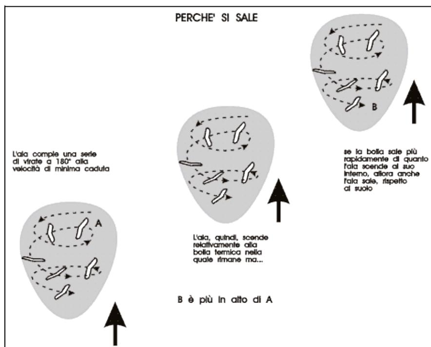
**Figura 8-7.** Per poter sfruttare le ascendenze termiche è necessario saper compiere virate coordinate e continue a 360° mantenendosi costantemente all'interno della zona di ascendenza. La capacità di effettuare i 360° volando alla velocità di minima caduta può far la differenza tra salire o scendere, nelle giornate "deboli".
