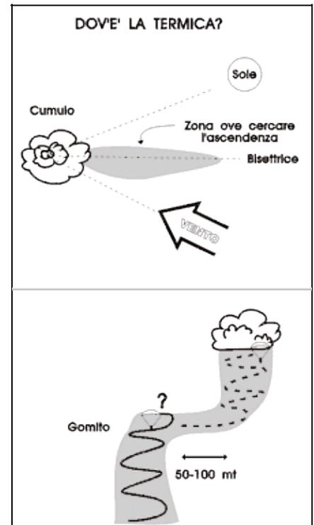
**Figura 8-5.** La zona di ascendenza deve essere ricercata sulla bisettrice dell'angolo che il cumulo forma con il sole e con la direzione del vento. A volte le termiche formano veri e propri gomiti, e proseguono sottovento.
