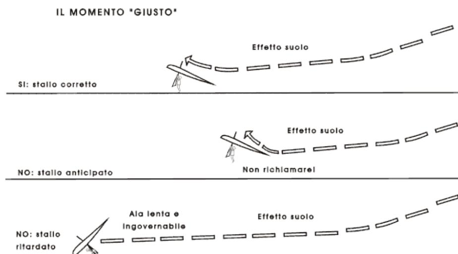
**Figura 5-16.** Stallando troppo presto il delta si rialza, ritardando esso non si ferma, ma spancia fino al suolo.
