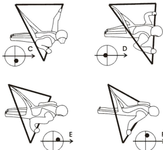
**Figura 5-21.** Virata coordinata: C=spostamento laterale del peso; D=spostamento indietro del peso (cabrata in virata); E=spostamento del peso in avanti (presa di velocità); F=spostamento laterale del peso nel senso opposto alla virata (per "centrare" l'apparecchio).
