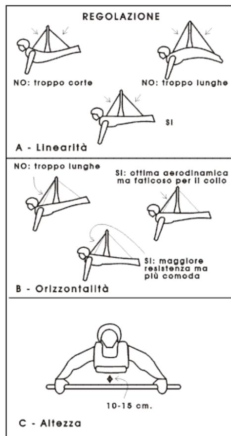
**Figura 5-8.** Le tre fasi della regolazione di un'imbragatura: linearità, orizzontalità e distanza dalla barra di controllo.
