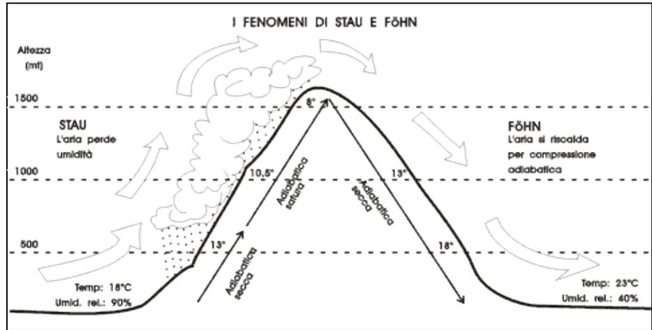
Figura 4-32. Lo stau ed il föhn: caratterizzato da precipitazioni il primo, da aria calda ed asciutta il secondo.
