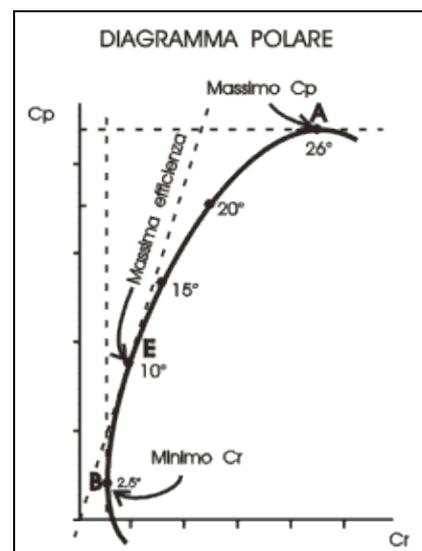
Figura 3-17. Diagramma Polare.
