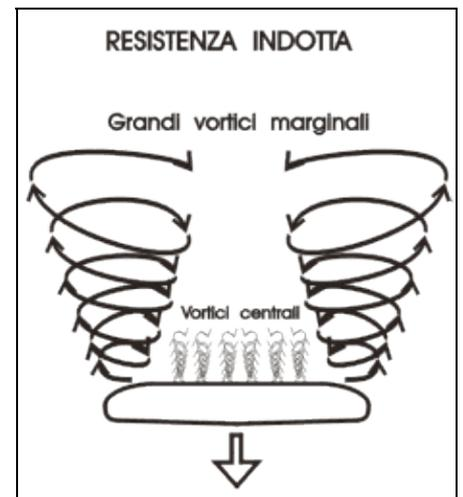
Figura 3-14. Resistenza indotta: è massima alle basse velocità.
