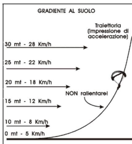
**Figura 6–21.** Il gradiente di vento al suolo può trarre in inganno, inducendoci ad un eccessivo (quanto rischioso) rallentamento in prossimità del terreno. La soluzione: sentire la velocità di volo con le orecchie, anzichè valutarla con gli occhi.
