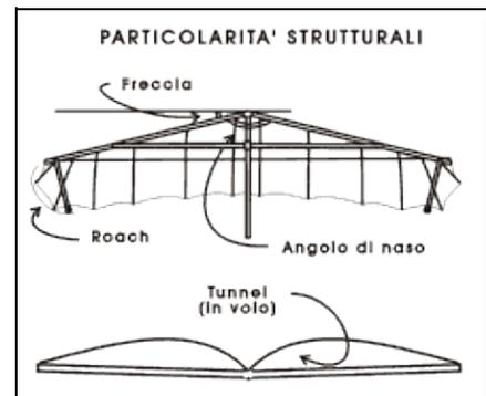
Figura 5-3. Angolo di naso, freccia a roach
