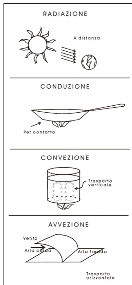
Figura 4-2. Le quattro modalità di trasmissione del calore.
