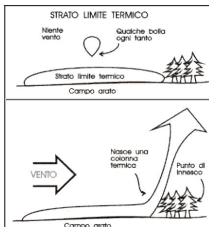
Figura 4-12. Strato limite termico e punti di innesco.
