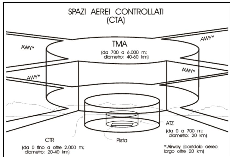
**Figura 2.1.** Spazi aerei controllati: le AWY confluiscono in un ampio cilindro, sollevato di 700–1000 metri rispetto al suolo, detto TMA. L'aeroporto è "circondato" da due cilindri: uno più piccolo, l'ATZ, ed uno più grande, il CTR.
