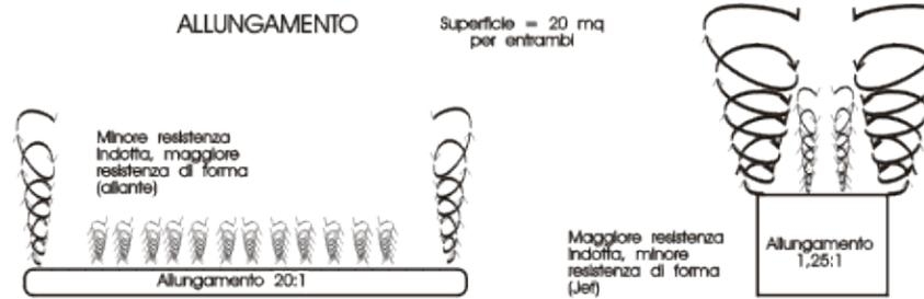
**Figura 3-24.** L'allungamento riduce la resistenza indotta: tale effetto è particolarmente rilevante per gli apparecchi che volano a basse velocità.
