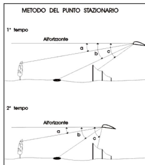
Figura 8-17 Trigonometria del punto stazionario (spiegazioni nel testo).
